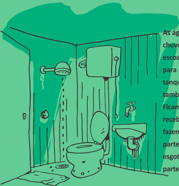
As águas da torneira, chuveiro e descarga são escoadas pela tubulação para as fossas sépticas ou tanques sépticos, como também são conhecidos. Ficam debaixo da terra e recebem os esgotos, que fazem a separação da parte sólida contida no esgoto e o tratamento da parte líquida.
